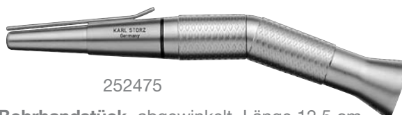
252475 INTRA-Bohrhandstück , abgewinkelt, Länge 12,5 cm, zur Verwendung von Bohrern mit glattem Schaft, Übertragung 1:1 (40.000 U/min)
