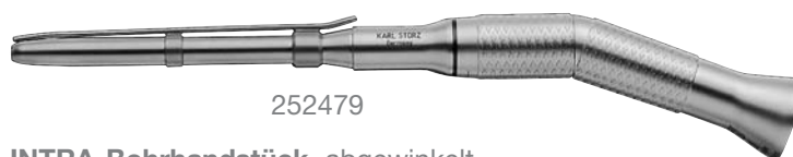
252479 INTRA-Bohrhandstück , abgewinkelt, extra lang , Länge 18 cm, zur Verwendung mit 12,5 cm langen Bohrern mit schlankem Schaft, Übertragung 1:1 (40.000 U/min)
